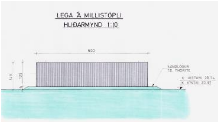
Mynd 6 – Legu úr gervigúmmí með stálstyrkingum á millistöplum
