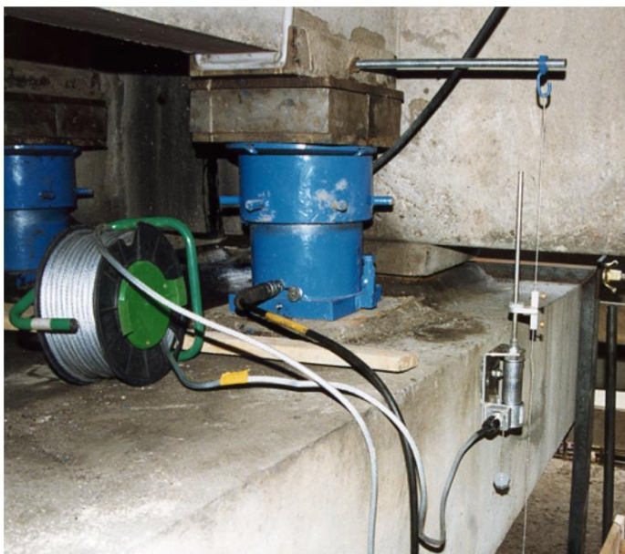
Mynd 21 frá Freyssinet, dæmi um tölvustýrðan lyftibúnað
